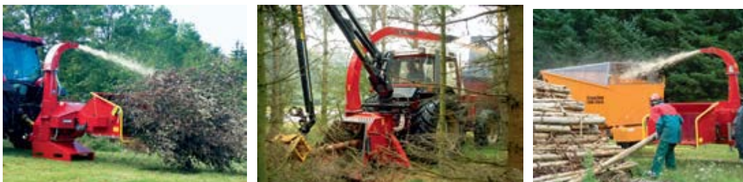
Εικόνα 9. Κινητή μονάδα θρυμματισμού ξύλου. (πηγή ambrakisbros.gr)
