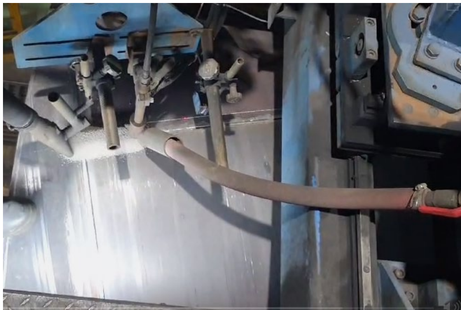
Εικόνα 39: Συγκόλληση εξωτερικής επιφάνειας στην εγκάρσια διεύθυνση
