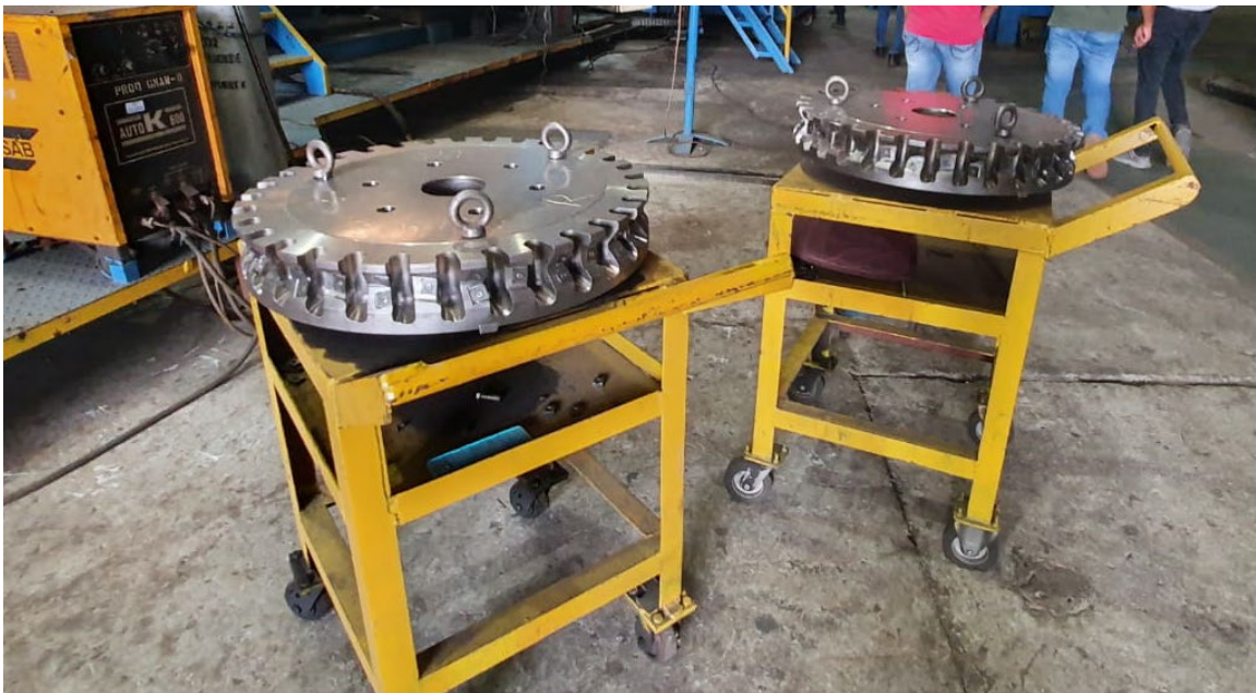
Εικόνα 20: Κεφαλές φρεζαρίσματος διαμήκων πλευρών ελάσματος
