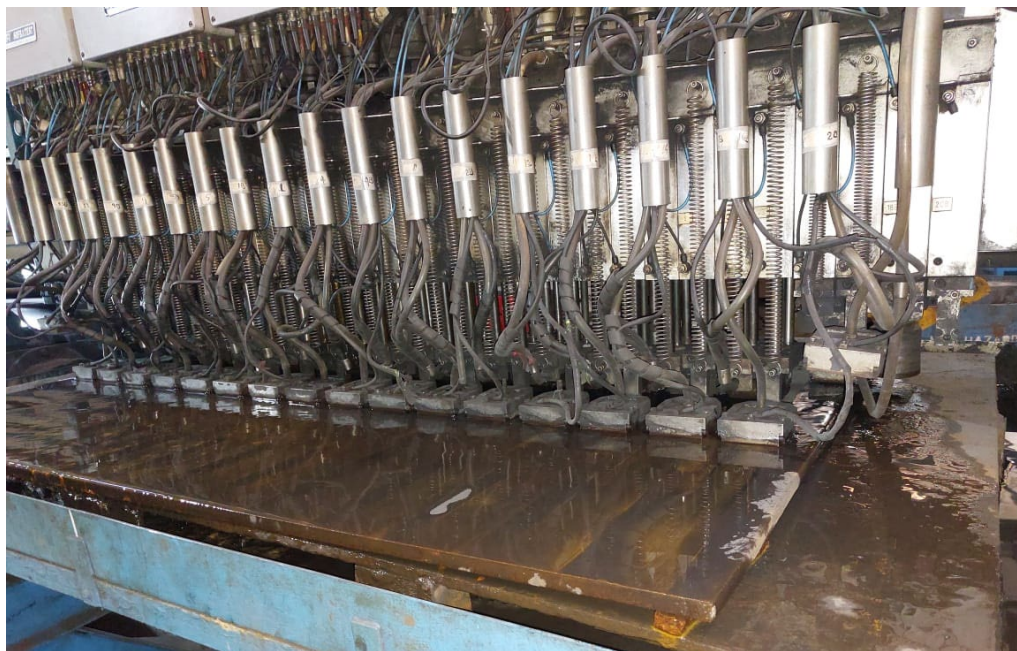
Εικόνα 29: Έλεγχος όλης της επιφάνειας του στροφείου με υπέρηχο
