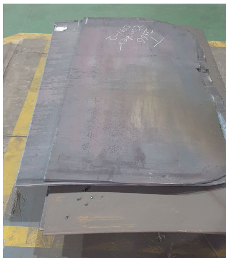
Εικόνα 3: Αποκομμένα τμήματα ελάσματος από την εγκάρσια ακμή του στροφαίου
