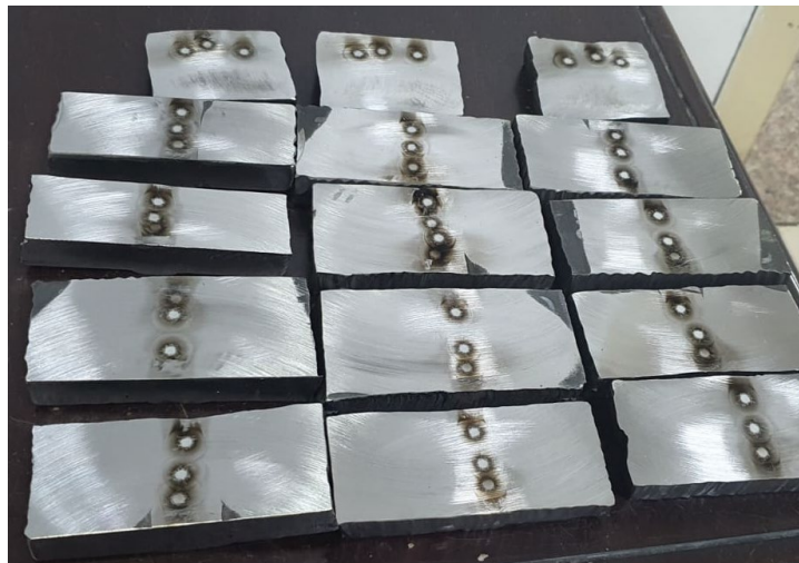
Εικόνα 12: Δοκίμια μετά από εξέταση από το φασματογράφο
