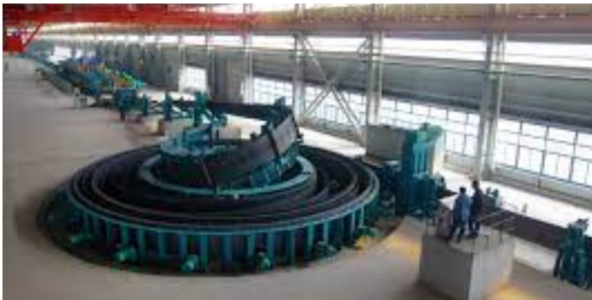
Εικόνα 25: Σημείο 3 - Σπειροειδής Συσσωρευτής ελάσματος
