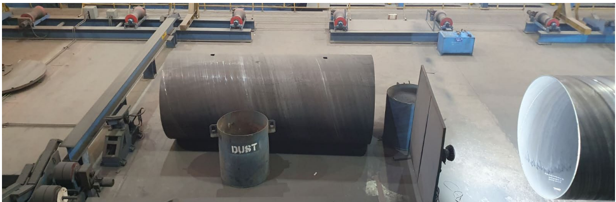
Εικόνα 35: Τμήμα σωλήνα που έχει υποστεί καταστροφική δοκιμή
