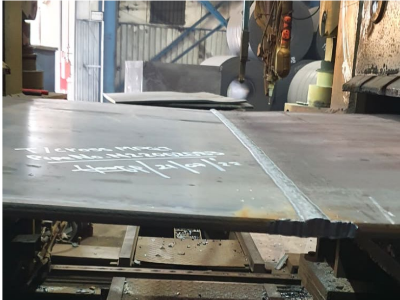
Εικόνα 19: Στροφείο συγκολλημένο εγκάρσια με το προηγούμενο
