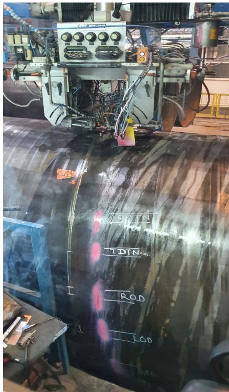
Εικόνα 5: Εντοπισμός με αυτόματη κεφαλή υπέρηχων των ασυνεχειών στη συγκόλληση
