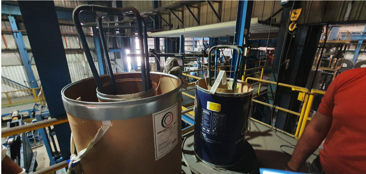
Εικόνα 21: Μέταλλο συγκόλλησης σε μορφή συνεχόμενου σύρματος
