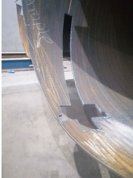
Εικόνα 34: Αφαίρεση μετάλλου από τμήμα σωλήνα για καταστροφική δοκιμή
