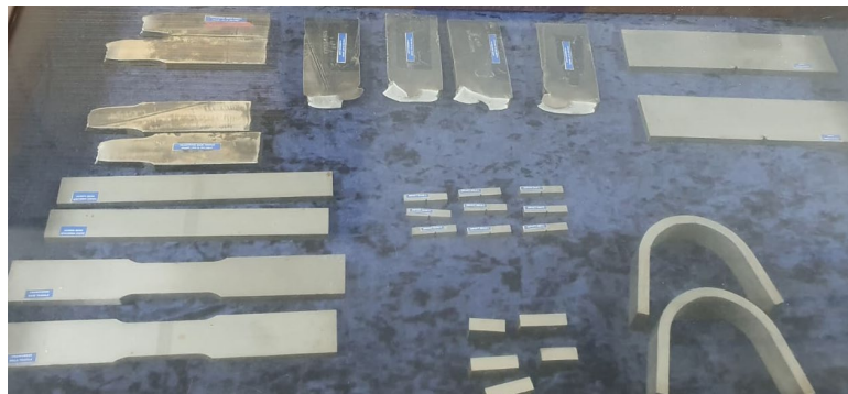
Εικόνα 13: Δοκίμια πριν και μετά από την εξέταση
