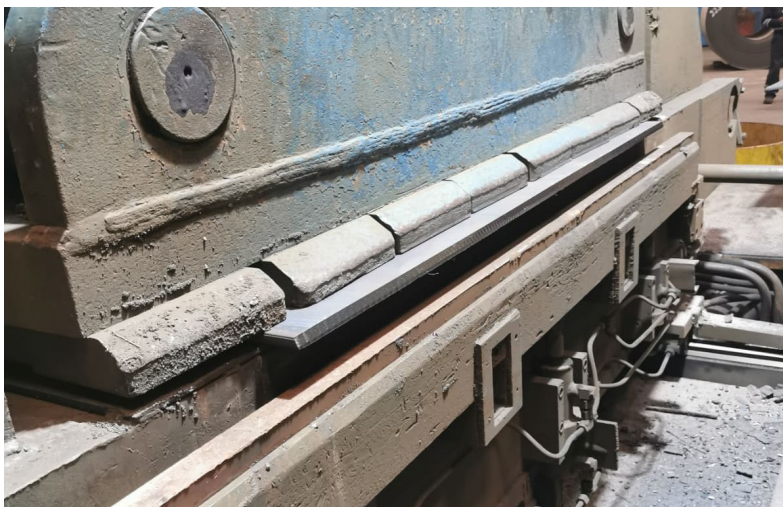
Εικόνα 37: Ακμή στροφείου με φρέζα στην εγκάρσια διεύθυνση
