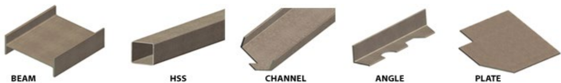
Εικόνα 6 : Τα σχήματα των χαλύβδινων στοιχείων (ATAD, 2022)
