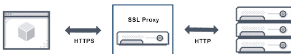
Σχήμα 4.1: Απεικονίζεται ένα δίκτυο TLS/SSL proxy.
