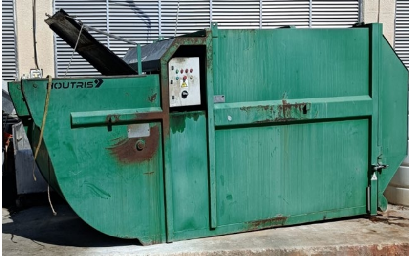
Εικόνα 11. Μεταλλικός κάδος με συμπιεστή για συλλογή των οικιακών απόβλητων του Νοσοκομείου.
