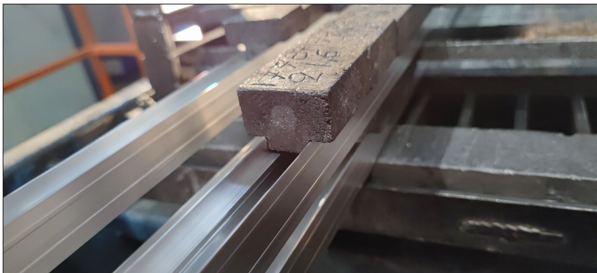
Σχήμα 37: Χρήση γραφίτη κατά την διέλαση αλουμινίου. Πηγή: Εξεταζόμενη επιχείρηση
