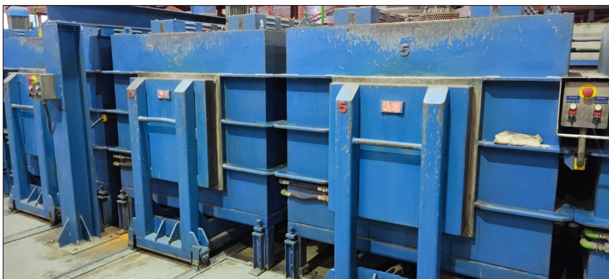
Σχήμα 5: Φούρνοι προθέρμανσης μητρών Πηγή: εξεταζόμενη βιομηχανία
