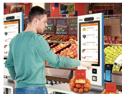
Εικόνα 1: Μηχανές self service checkout
