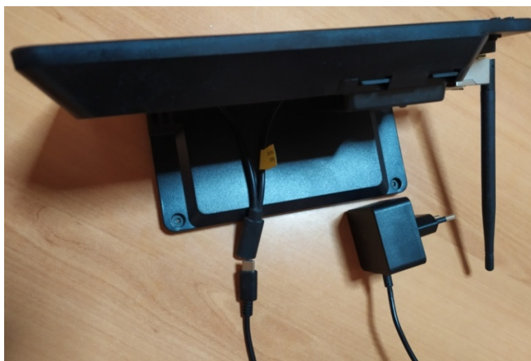
Εικόνα 17. Σύνδεση τροφοδοσίας με καλώδιο δύο διακλαδώσεων σε οθόνη και Raspberry Pi 4B.
