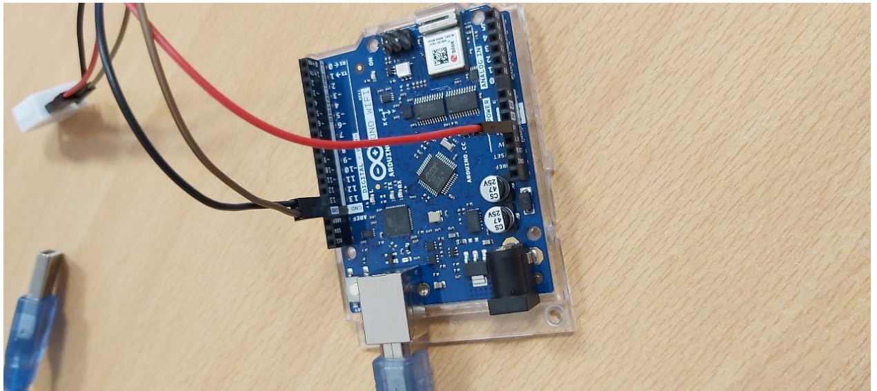
Εικόνα 4.8 - Arduino uno Rev 2 με temperature sensor και ενσωματωμένο module για Wi-Fi
