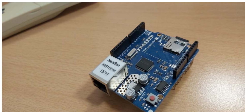
Εικόνα 4.6 – Το ethernet module για δοκιμές δικτύωσης και αποστολής καταγεγραμμένων εντολών IR
