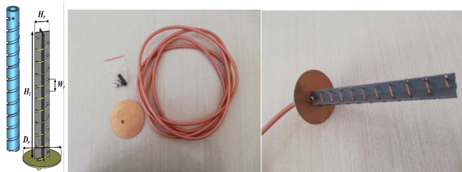
Εικόνα 19, Υλικά Κατασκευής και Ελικοειδής Κεραιά Ραδιοεντοπιστή Drone 5.8 GHz
