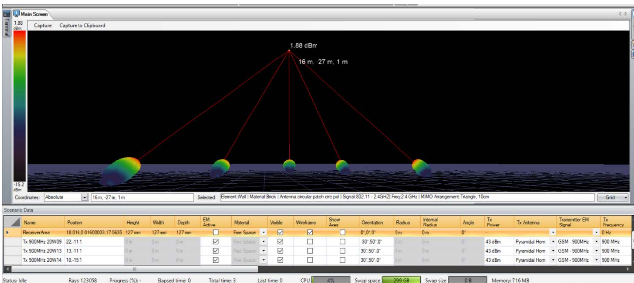
Εικόνα 59, Προσομοίωση Εκπομπής Ενέργειας Trunet, σε Drone στην απόσταση 20μ, ύψος 10μ, από 5 οχήματα φόρτισης με ισχύ εκπομπής, 20W έκαστο
