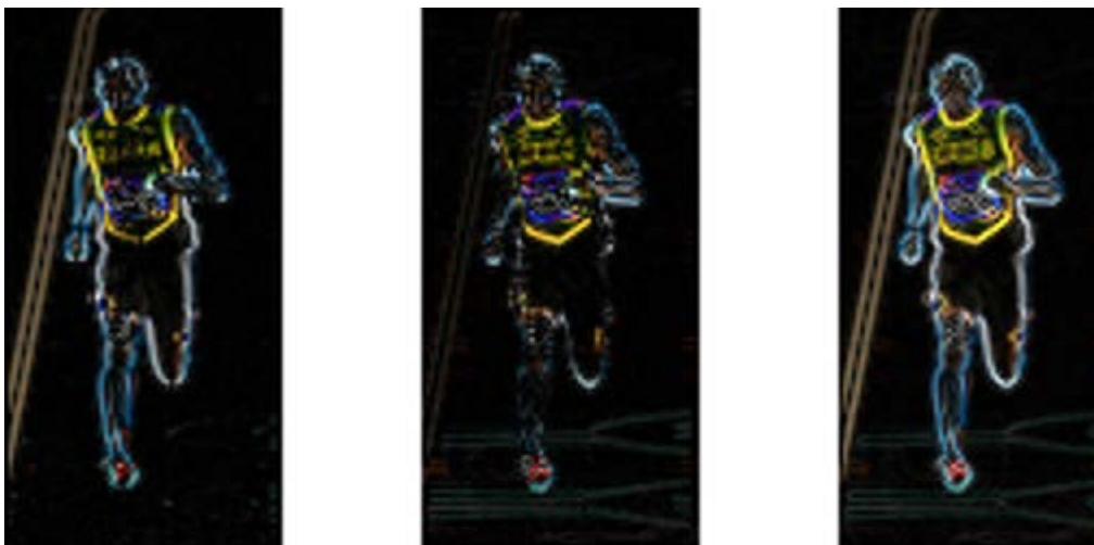
Εικόνα 11: Κατευθυνόμενα διανύσματα στον άξονες xx , yy και συνισταμένη (Πηγή: OpenCV)
