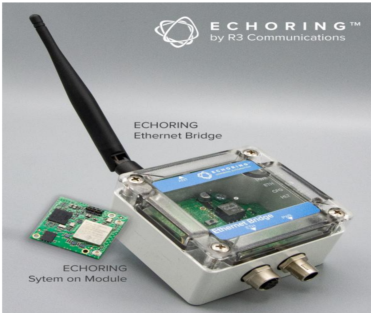
Εικόνα 2: Προϊόν δικτύωσης για εφαρμογές M2M με μέγιστη καθυστέρηση 1msec
