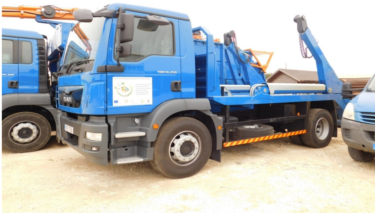
Εικόνα 10: Εικόνα οχήματος για μεταφορά κάδων τύπου skip
