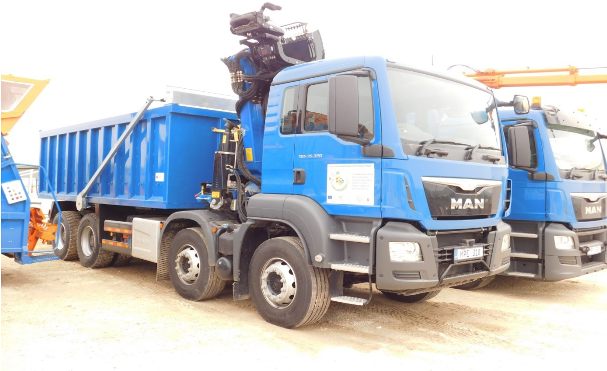
Εικόνα 8: Όχημα με κρίκο και γερανό
