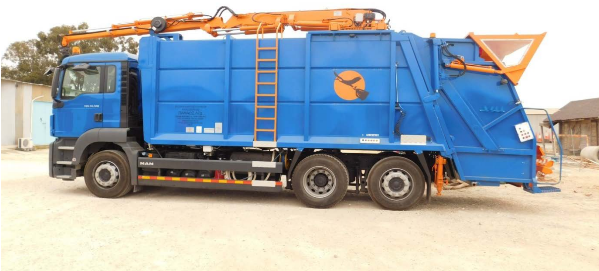
Εικόνα 9: Απορριματοφόρο όχημα με γερανό
