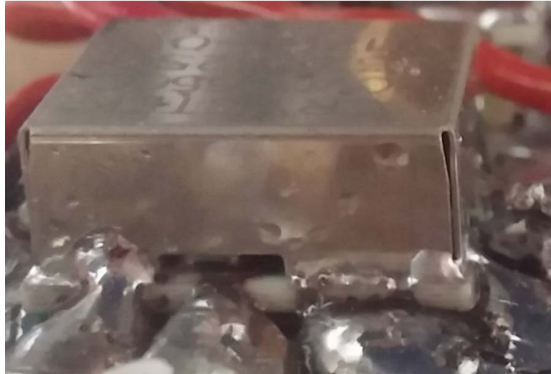
Εικόνα 8.16: Χάλκινο strip συγκολλημένο σε pin του VCO (πλάγια όψη)
