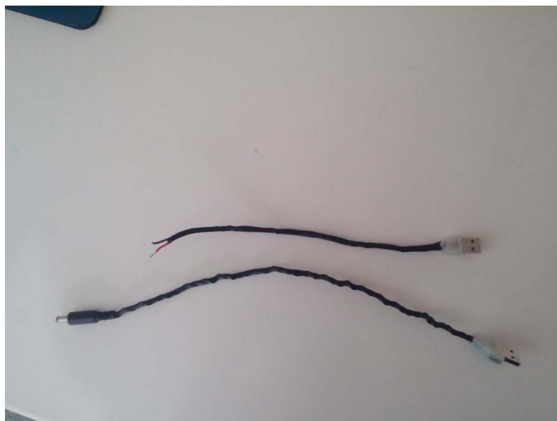
Εικόνα 8.39: Τα δύο αυτοσχέδια καλώδια τροφοδοσίας του συστήματος τα οποία θα μεταφέρουν ρεύμα από το Power Bank
