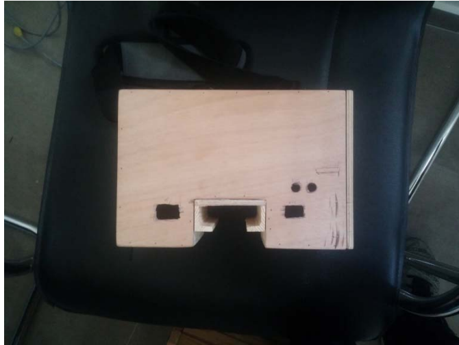
Εικόνα 8.40: Πλάγια όψη του κουτιού όπου φαίνεται η θέση εφαρμογής του Power Bank και οι εισοδοί των καλωδίων τροφοδοσίας και των 2 antenna cables
