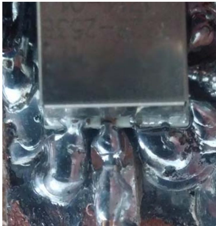
Εικόνα 8.15: Χάλκινο strip συγκολλημένο σε pin του VCO (κάτοψη)
