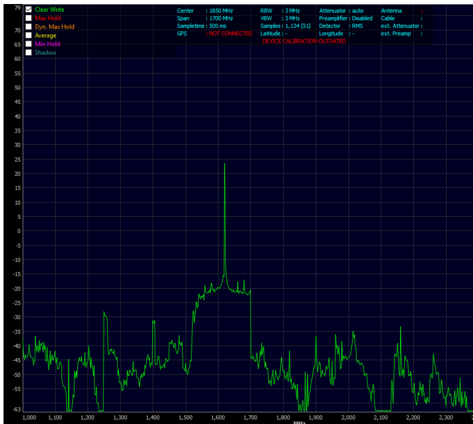
Εικόνα 8.25: Προβολή στο spectrum analyzer της συνάρτησης δέλτα η οποία συγκεντρώνει όλη την ισχύ σε συγκεκριμένη συχνότητα
