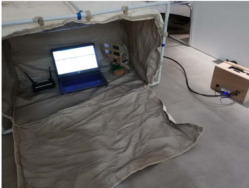
Εικόνα 9.5: Απεικόνιση της διάταξης υλοποίησης Jamming σε Wi-Fi Signal με τη χρήση του EMR Insulation κλωβού
