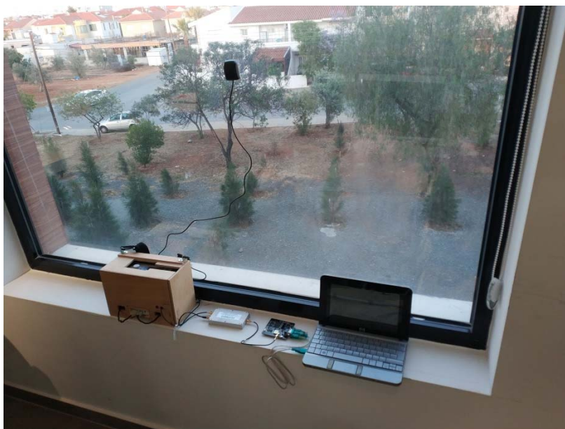
Εικόνα 9.4: Απεικόνιση της διάταξης υλοποίησης Jamming σε GPS Signal
