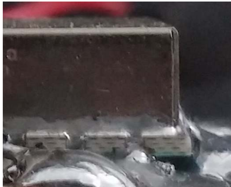
Εικόνα 8.17: Πλάγια όψη του συγκολλημένου στην πλακέτα VCO
