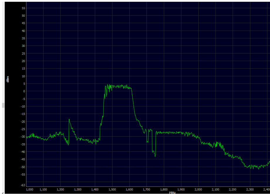
Εικόνα 8.28: Η παραγόμενη μπάντα επικεντρωμένη στη συχνότητα L1 του GPS
