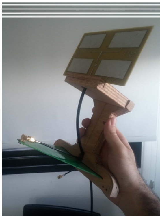
Εικόνα 8.38: Η εφαρμογή των δύο κεραιών σε ξύλινο handle και ο τρόπος χρήσης του
