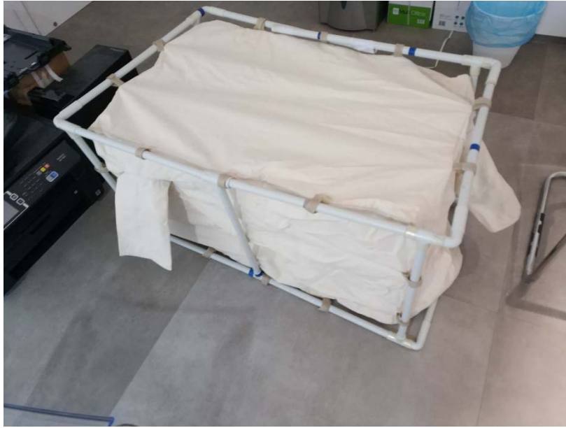
Εικόνα 9.2: Ο πτυσσόμενος κλωβός με το Yshield ύφασμα που παρέχει EMR insulation
