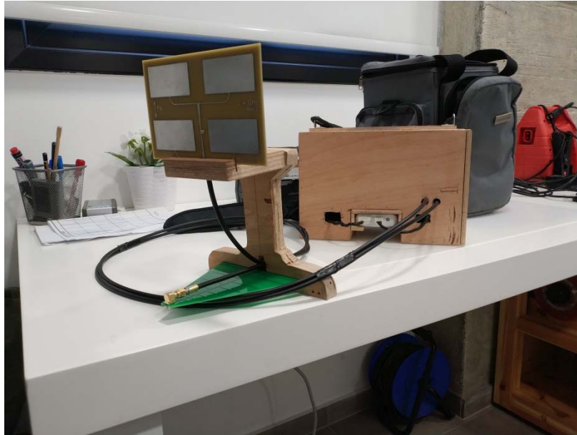
Εικόνα 9.1: Το σύστημα Jammer μετά την ολοκλήρωση του
