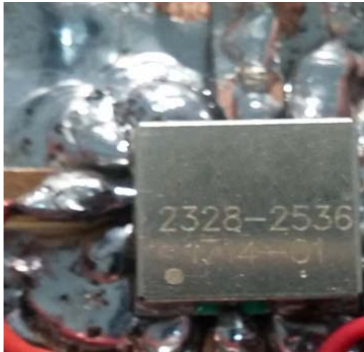
Εικόνα 8.14: Ο VCO συγκολλημένος στην πλακέτα. Ξεχωρίζει η κόλληση σε κάθε pin
