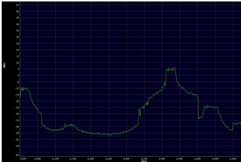
Εικόνα 8.27: Η μεταβολή στο εύρος και ισχύς της παραγόμενης μπάντας μετά από μεταβολή στο offset και στο amplitude
