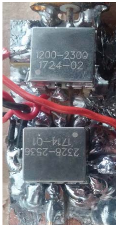
Εικόνα 8.21: Mirror διάταξη των 2 VCOs
