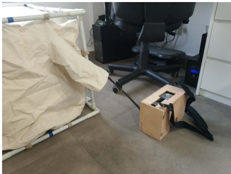
Εικόνα 9.6: Το σημείο διέλευσης των SMA Cables τα οποία μεταφέρουν το Jamming Signal στο εσωτερικό του κλωβού
