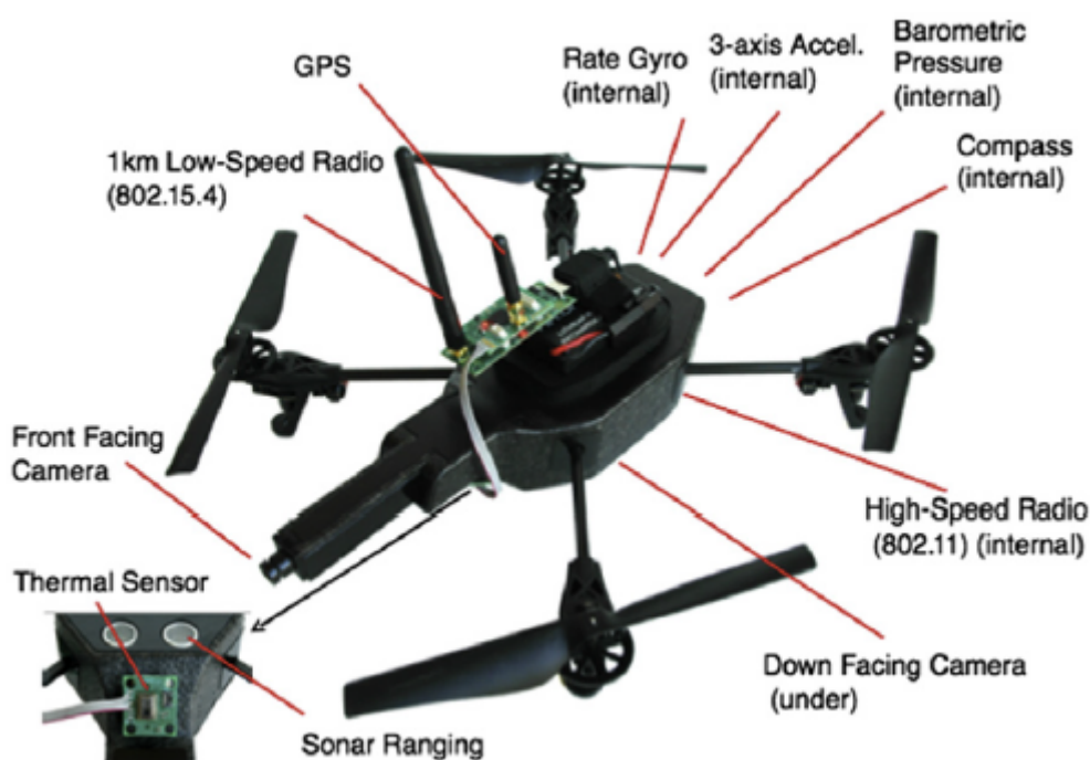
Εικόνα 4.1: Δομή ενός εμπορικού Drone
