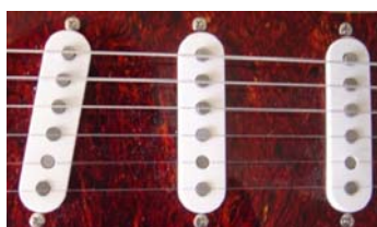
Σχήμα 2.6: Pickups από ηλεκτρική κιθάρα. Το πηνίο είναι ένα είδος μαγνητικού μετατροπέα που μετατρέπει την ηλεκτρομαγνητική δόνηση των χορδών σε ηλεκτρικό σήμα.
