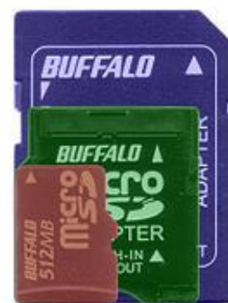
Εικόνα 2.12β Σύγκριση μεγέθους SD, miniSD, microSD
