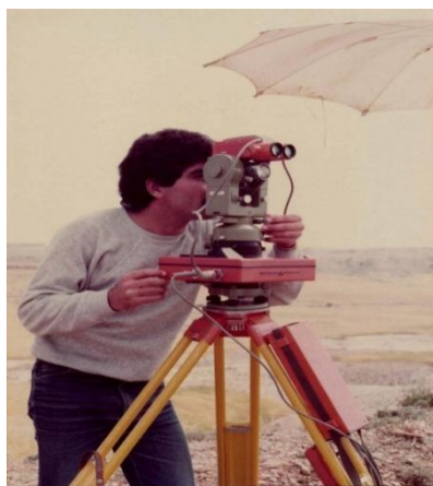
Χωρομέτρης χρησιμοποιεί το Distomat E.D.M
