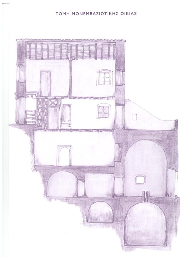
Εικόνα 2.13: Σχηματική τομή τυπικής μονεμβασιώτικης οικίας. (5η ΕΒΑ, 2001)
