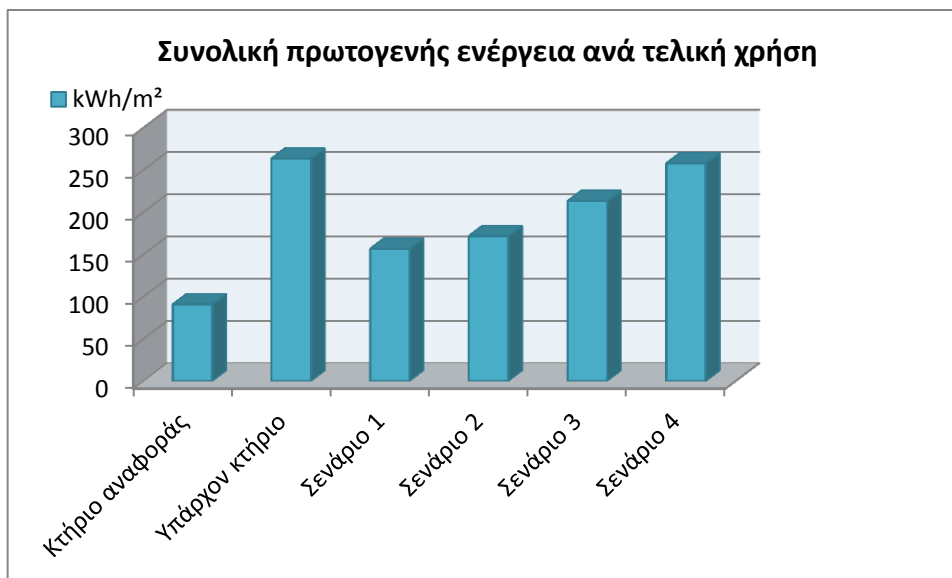
Διάγραμμα 5.1: Συνολική πρωτογενής ενέργεια ανά τελική χρήση (kWh/m 2 ) για το κτήριο αναφοράς, το υπάρχον κτήριο και τα σενάρια.
