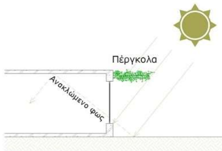
Εικόνα 2.10: Οριζόντιο σκίαστρο με πέργκολα με φυτά (τεχνική οδηγία TEE, 2012)
