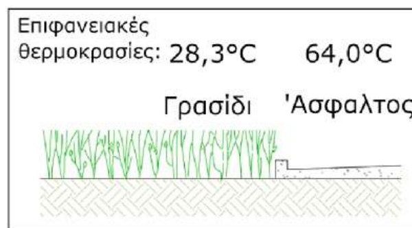
Εικόνα 2.11: Μετρήσεις επιφανειακών θερμοκρασιών σε φυτεμένη επιφάνεια με γρασίδι και σε άσφαλτο κατά τη διάρκεια της ημέρας το καλοκαίρι (τεχνική οδηγία TEE, 2012)
