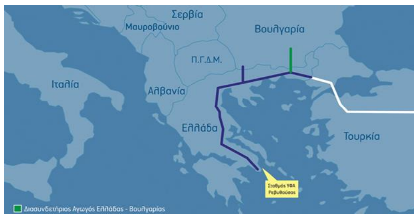
Εικόνα 2.6: Κάθετος διασυνδετήριος αγωγός Ελλάδας – Βουλγαρίας (IGB) για τη σύνδεση με τον αγωγό TAP (ICGB AD, 2015)
