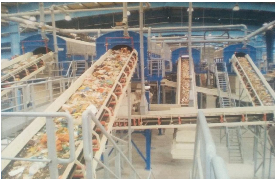
Εικόνα 4.1: Πρωτοβάθμιος και δευτεροβάθμιος διαχωρισμός υλικών
