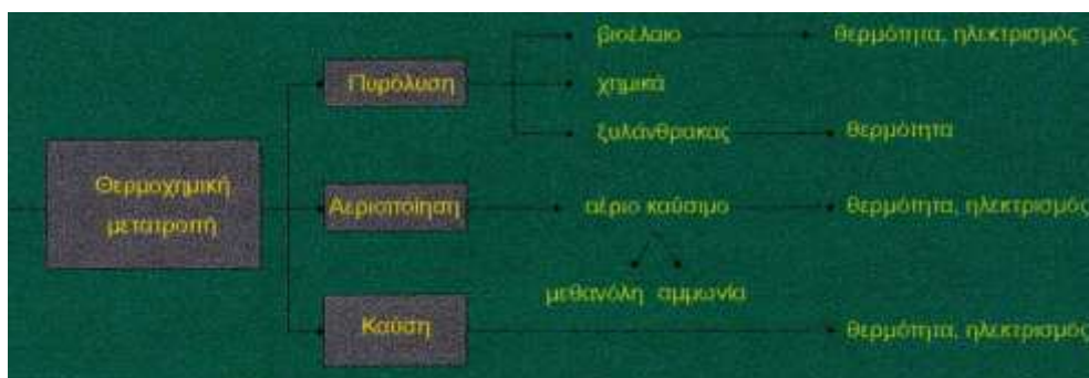
Διάγραμμα 2. Θερμοχημική μετατροπή της βιομάζας
