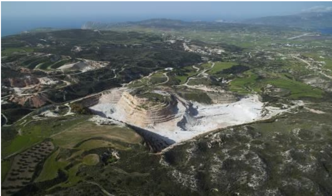
Εικόνα 1.1: Λατομικός χώρος στη ν. Μήλο. Είναι εμφανής η απότομη αλλαγή του τοπίου λόγω των εκσκαφών, των γεωμετρικών μορφών και των κάθετων επιφανειών που δημιουργούνται. Πηγή: ΛΑΒΑ Α.Ε.,2014.
