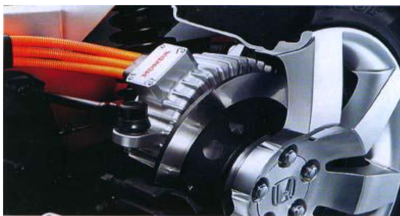
«in-hub ηλεκτροκινητήρας» των πίσω τροχών, ισχύος 25\text{ kW} ο καθένας
