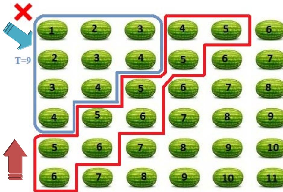
Εικόνα 13. Για T ταξίδια του ρομπότ οι πρώτοι και τελευταίοι καρποί συλλογής πρέπει να είναι οι πλησιέστεροι στο σημείο εκφόρτωσης
