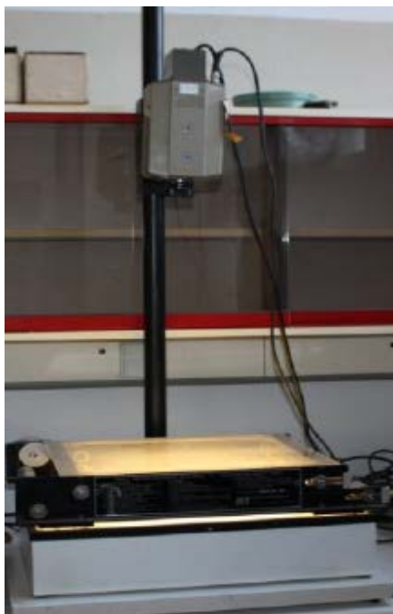
Εικόνα 3.4: Συσκευή μέτρησης Φυλλικής Επιφάνειας (LAI)
