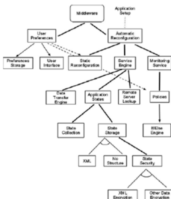
Εικόνα A.17: Αυτόματη αναδιάρθρωση και διάσπαση υπολογιστικού τμήματος σε μικρότερα τμήματα.
